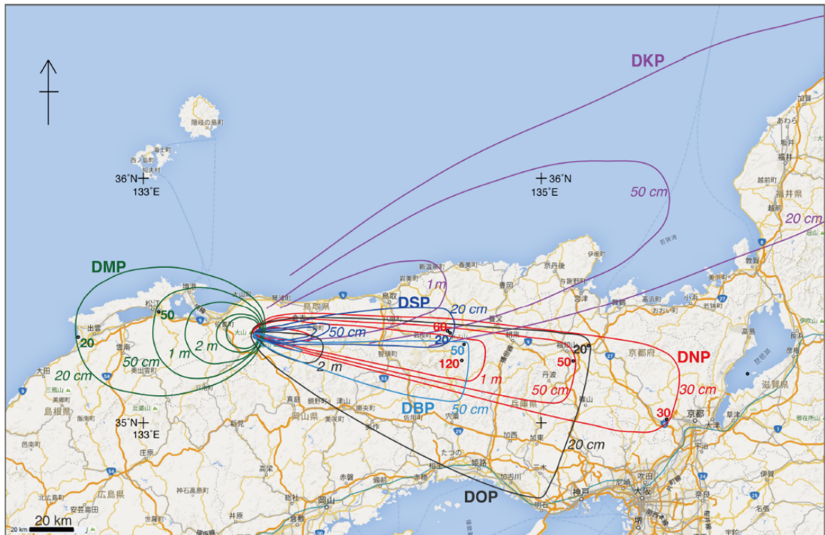
第9図 大山火山起源の降下火砕堆積物の分布。DKP = 倉吉降下火砕堆積物(町田・新井, 1979; 竹本, 1991); DSP = 関金降下火砕堆積物(町田・新井, 1979; 加藤ほか, 2001); DNP = 生竹降下火砕堆積物(町田・新井, 1979; 井本ほか, 1989; 野村, 1994; 加藤ほか, 2001; 小滝ほか, 2002); DMP = 松江降下火砕堆積物(町田・新井, 1979); DBP = 別所降下火砕堆積物(岡田・石賀, 2000; 加藤ほか, 2001); DOP = 奥津降下火砕堆積物(加藤ほか, 2004; 小滝ほか, 2002)。数字は堆積物の厚さで, 単位はcm。DKPの等層厚線は竹本(1991)による。他の等層厚線は, 岡田・石賀(2000)の大山近傍のものに遠方のデータを加えて作成した。基図にはGoogleマップを用いた。
