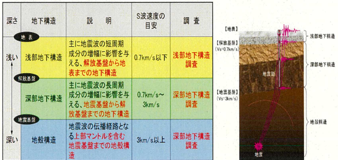
【図 2 0 地震動評価のための地下構造の定義及び概念図】
