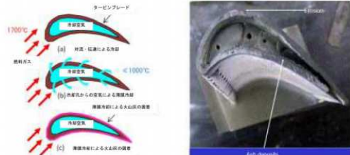
タービンブレードの冷却による火山灰の影響 (左)模式図、(右)付着事例 (安田・他, 2011)
