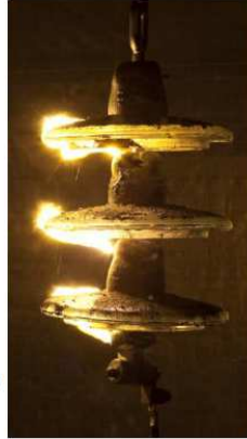
火山灰を用いた碍子の閃絡実験(Wilson et al. 2011)
